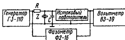
Рис. 4.12. Схема измерительной цепи для измерения больших по модулю импедансов.
