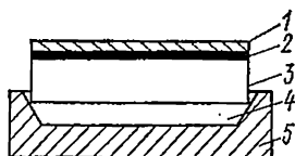
Рис. 9.3. Схема использования ЖКП для визуализации теплового поля пьезоэлемента.
